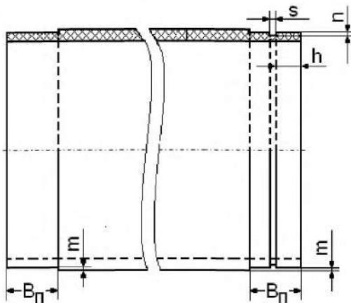
$B_{\Pi}$  – ширина шлифования под муфту;  $m$  – глубина шлифования под муфту;
