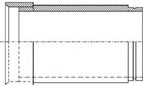
Рисунок 5.1 – Вариант поставки с одной установленной муфтой
