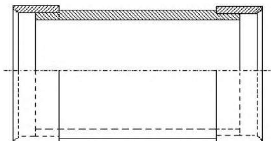
Рисунок 5.2 – Вариант поставки с двумя установленными муфтами
