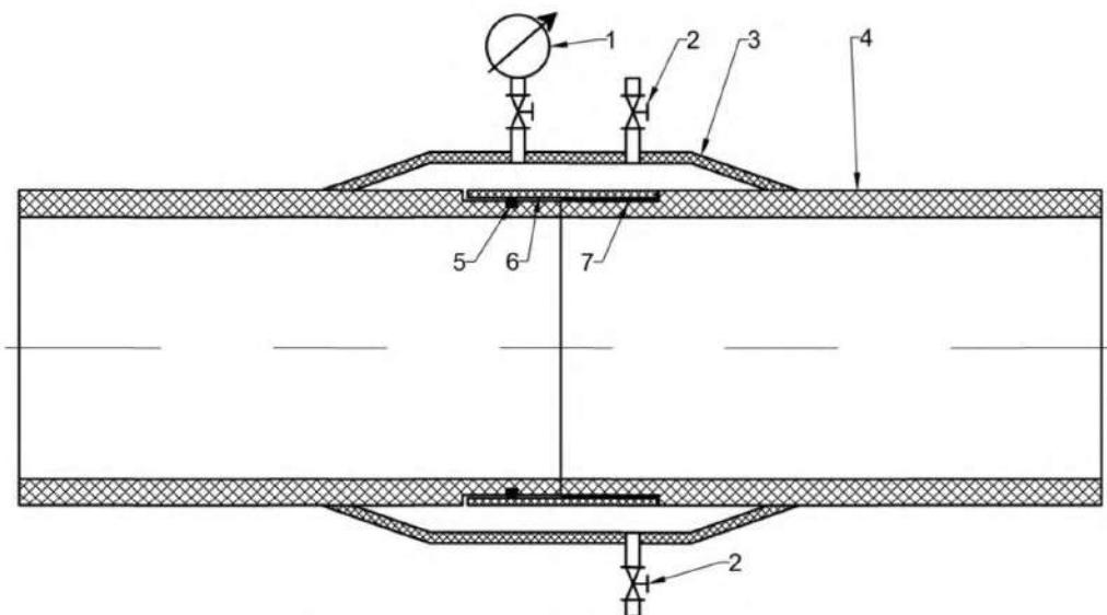
1 – манометр; 2 – вентили впуска/выпуска; 3 – кожух из стеклокомпозита;
