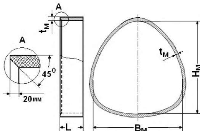
$B_M$  – ширина соединительной муфты по внутренней поверхности стенки;
