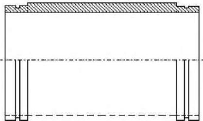
Рисунок 5.2 – Вариант поставки без установленных муфт
