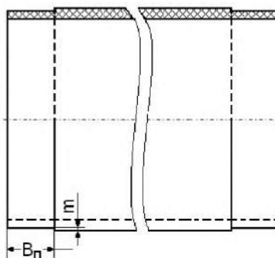
$B_{\text{п}}$  – ширина шлифования под муфту;  $m$  – глубина шлифования под муфту
