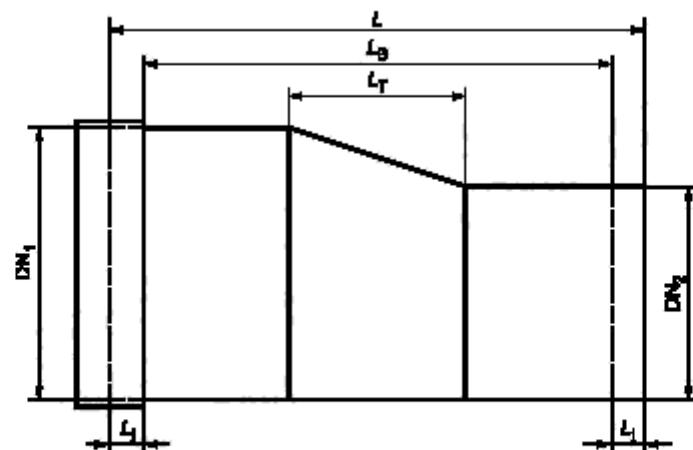
б — Переходник с эксцентрическим расположением концевых отверстий
