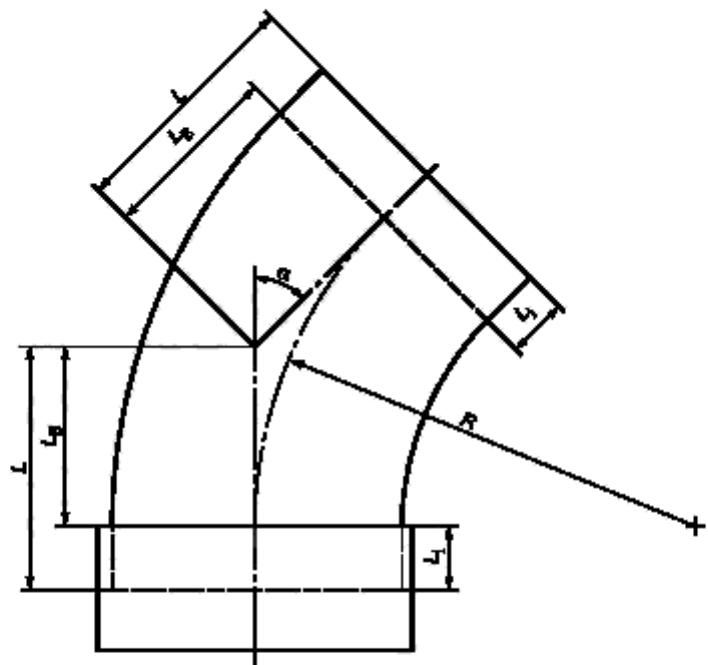
$L_b$  — длина корпуса;  $L$  — длина укладки;  $L_i$  — глубина входа;  $\alpha$  — установочный угол;  $R$  — радиус кривизны
