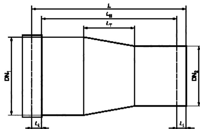
а — Переходник с концентрическим расположением концевых отверстий
