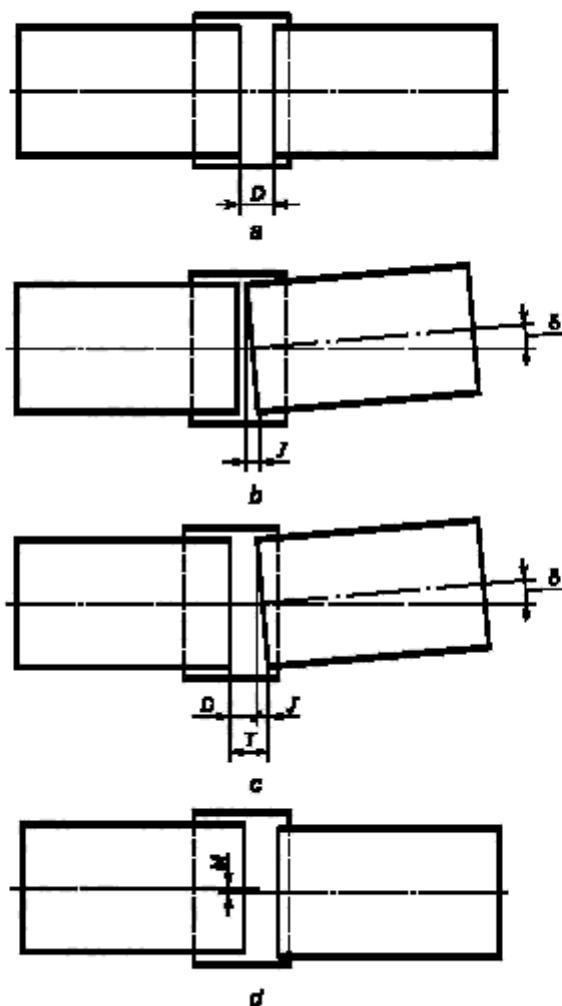
$D$  — расхождение стыка;  $J$  — продольное смещение, возникающее из-за углового отклонения соединения;
