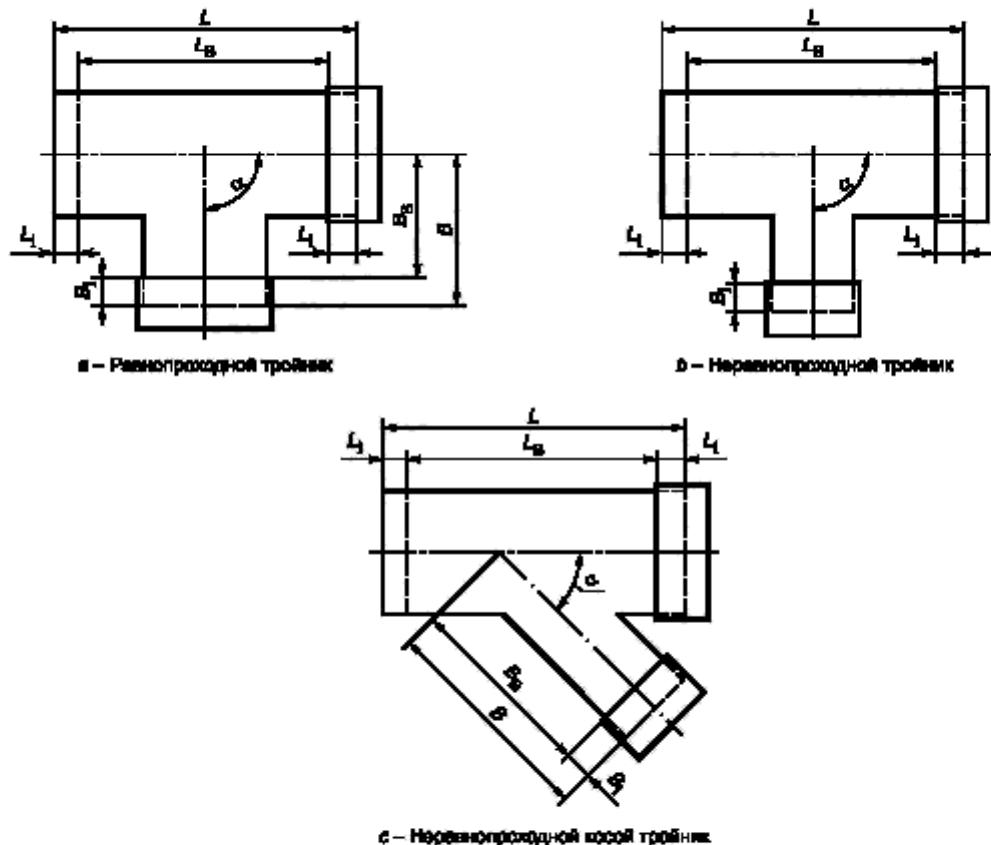
$\alpha$  — установочный угол;  $B$  — длина укладки тройника;  $B_B$  — длина деформации тройника;  $B_1$  — глубина входа раструба тройника;  $L$  — длина укладки главного трубопровода;  $L_B$  — длина корпуса главного трубопровода;  $L_1$  — глубина входа раструба главного трубопровода
