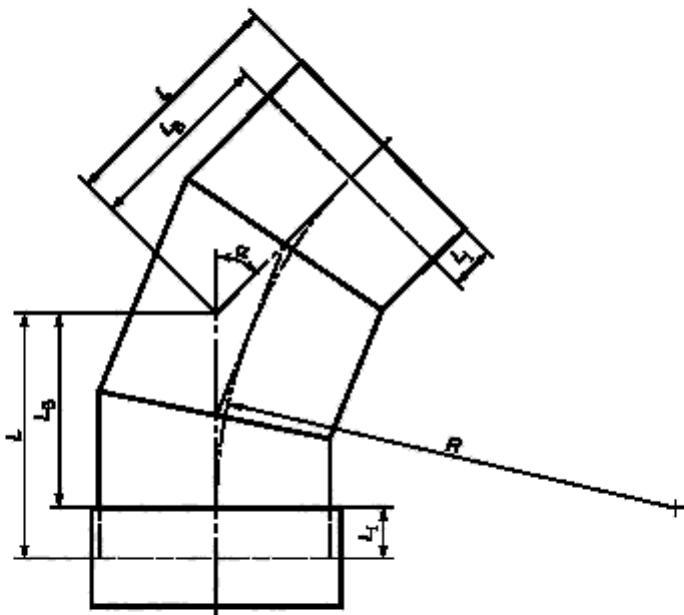
$L_b$  — длина корпуса;  $L$  — длина укладки;  $L_i$  — глубина входа;  $\alpha$  — установочный угол;  $R$  — радиус кривизны
