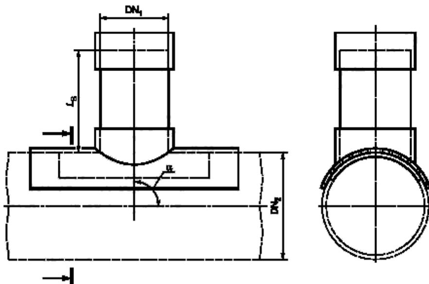
DN<sub>1</sub> — номинальный диаметр отводной трубы; DN<sub>2</sub> — номинальный диаметр главной трубы; L<sub>1</sub> — длина отводной трубы;
